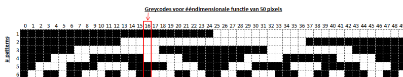
Figuur 3.13: Een voorbeeld waar de resolutie van de patronen geen macht van 2 zijn. De patronen zijn aangemaakt, beginnende van laag 7. De graycode voor bijvoorbeeld pixel 16 zal 0011000 zijn.
