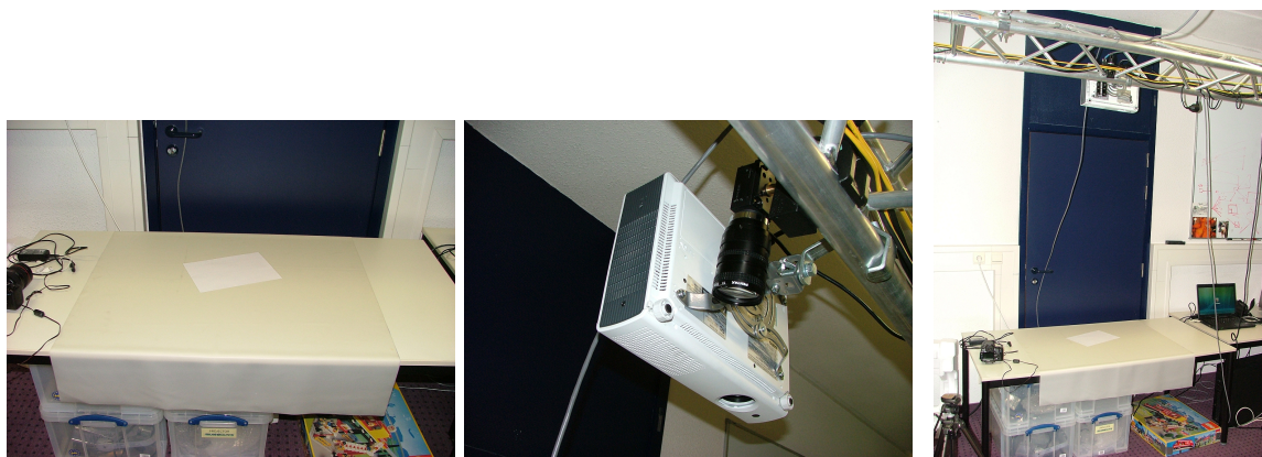
Figuur 3.1: De opstelling die wij gebruikt hebben voor de implementatie. Het bevat een tafel met een diffuus doek, een camera en projector loodrecht op de tafel gericht.
