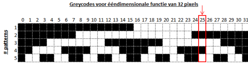
Figuur 2.3: Graycodes ontwikkeld door Inokuchi et al. [39]. Deze Figuur [54] geeft graycodes weer over een bereik van 32 pixels. De graycode voor pixel 25 is bijvoorbeeld 01010
